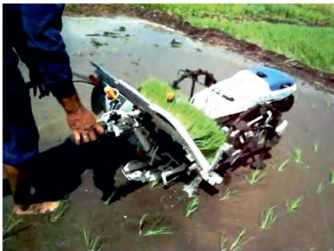
FIGURA 6. Labor de trasplante mecanizado con el semillero en bandeja y la máquina ISEKI.
