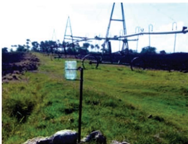
FIGURA 2. Instalación de recipiente pluviométrico No. 2
