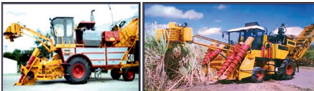
FIGURA 1. Modelos de cosechadoras de caña de azúcar KTP de fabricación nacional.
