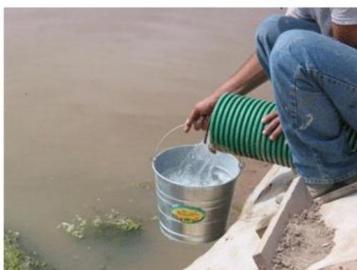
FIGURA 11. Medición del gasto en colector.
