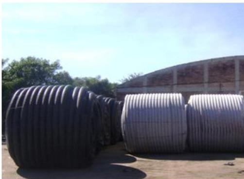
FIGURA 4. Tubería de 4" ranurada y con filtro y de 6" sin ranurar.
