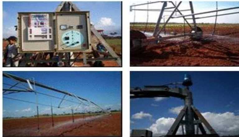
FIGURA 1. Partes esenciales de la estructura de la máquina de riego de pivote central OTHECH IRIMEC.
