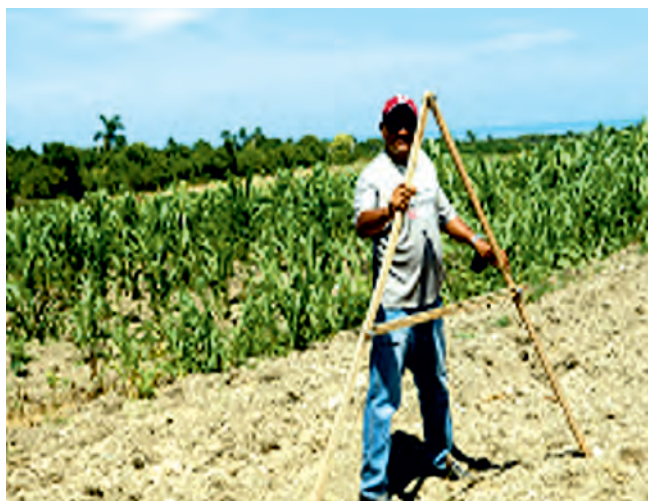
FIGURA 1. Aparato "A". Instrumento para determinar el desnivel del suelo.
