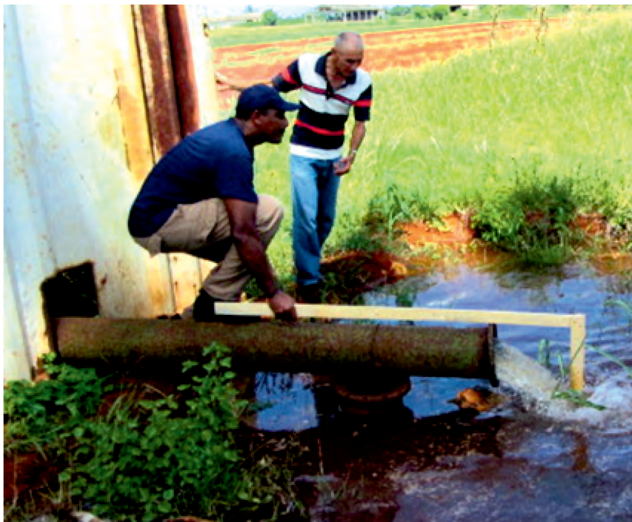
FIGURA 4. Forma de colocar la regla escuadra.
