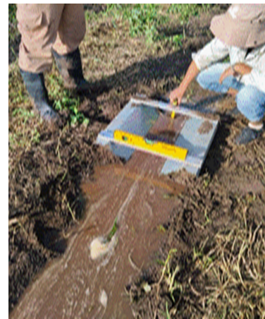
Figura 4. Medición del caudal en el surco con empleo de vertedor.
