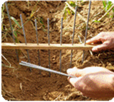
Figura 2. Uso del perfilómetro para la caracterización geométrica del surco.
