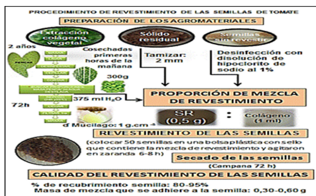
FIGURA 11. Procedimiento propuesto para el revestimiento de semillas de tomate con residuos naturales.
