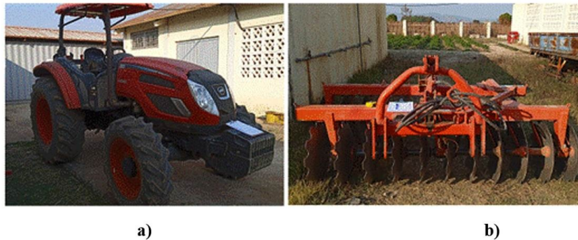
FIGURA 1. Tractor Kioti modelo PX 1002 e a grade integral Joper modelo GMH-22-24 de 920 kg utilizados em amaciar de solo. Fonte: O autor.
