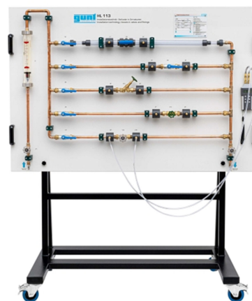
FIGURA 6. Banco de pruebas para válvulas y accesorios de riego.
