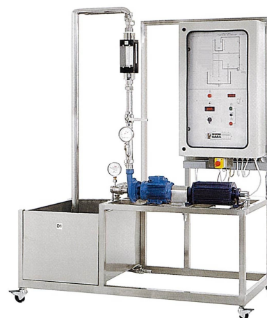
FIGURA 8. Banco de pruebas de bombas centrífugas.
