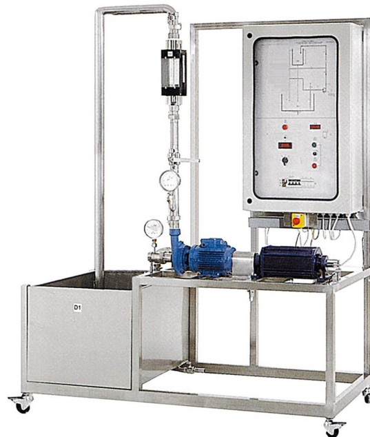
FIGURA 8. Banco de pruebas de bombas centrífuga.
