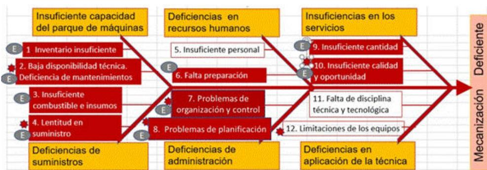
Figura 12. Factores que inducen a deficiencias en la mecanización.
