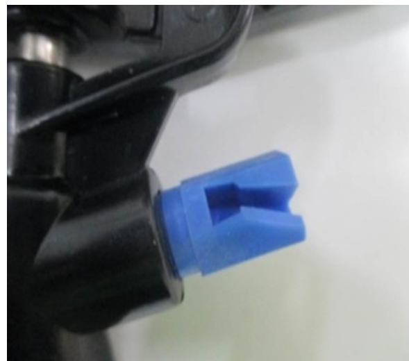
FIGURA 4. Detalle de la boquilla auxiliar 3,18 mm.
