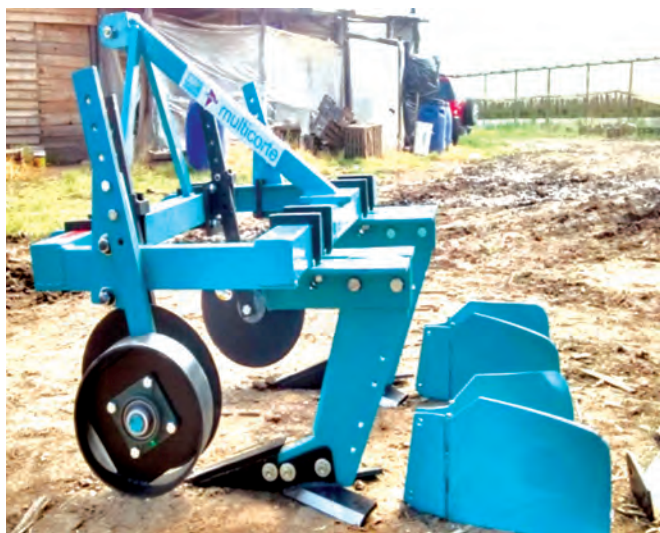
FIGURA 2. Multiarado (multicorte) M 120 para tractor de 45 hp.
