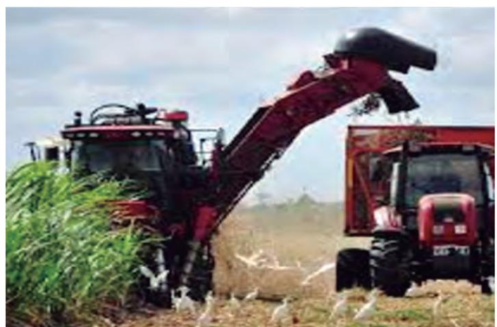
FIGURA 2. Tecnología de cosecha CASE 7000 + camión Kamaz y remolque.
