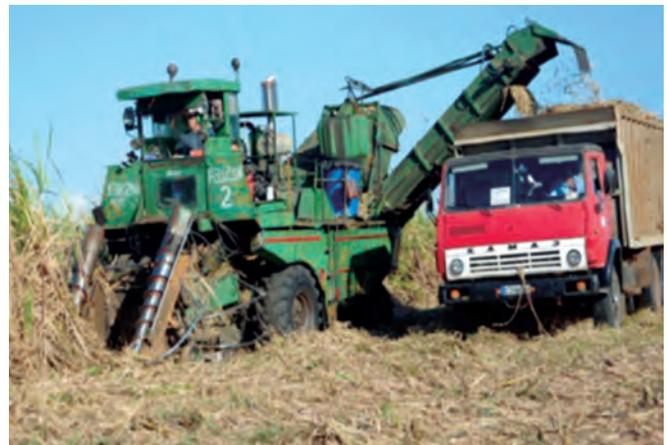
FIGURA 1. Tecnología de cosecha KTP-2M + camión Kamaz y remolque.
