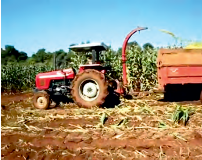
FIGURA 2. Conjunto formado por el tractor MF 275, la cosechadora KUHN MC 90S TWIN y el remolque.
