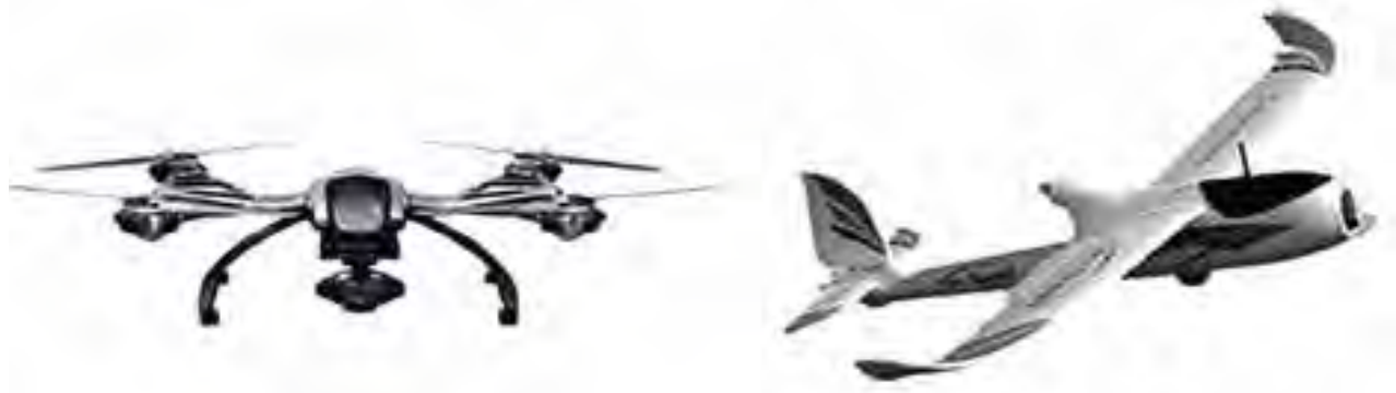
FIGURA 2. Drones utilizados en la agricultura: (a) multirrotor (cuadricóptero), (b) de ala fija.
