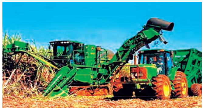
FIGURA 5. Medios de cosecha y transporte intermedio empleados para condiciones de cosecha con alta humedad de los suelos.
