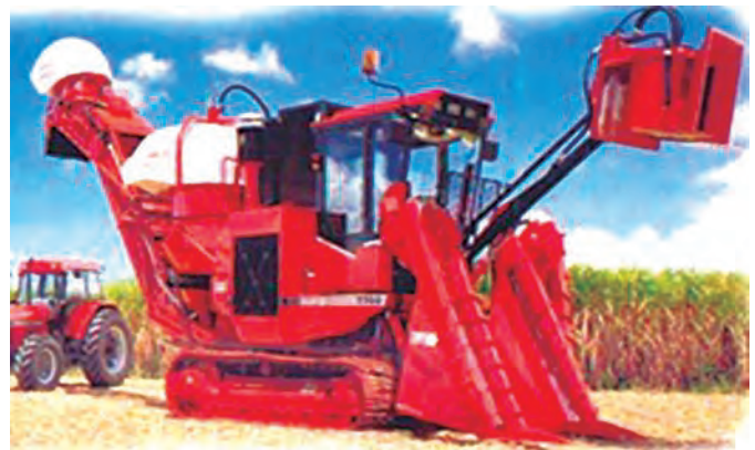
FIGURA 2. Cosechadora empleada en Australia para suelos con alta humedad (Rodríguez, 1999).
