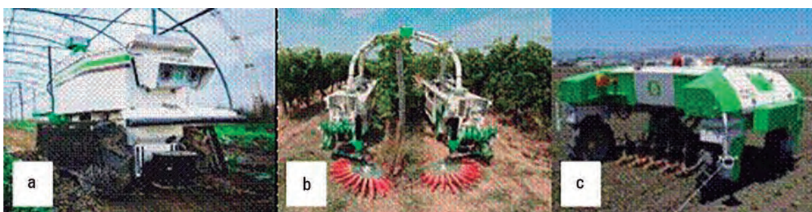
FIGURA 6. Robots desmalezadores desarrollados por la empresa francesa Naïo Technologies: a) OZ, b) Ted y c) Dino.
