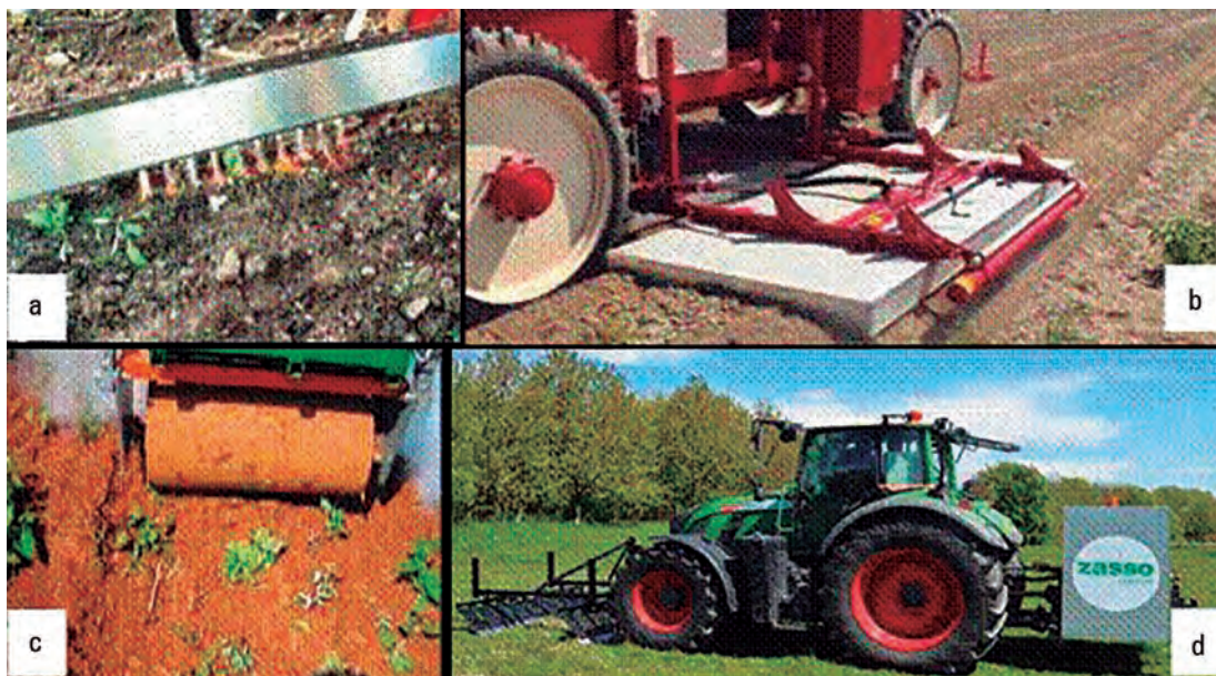
FIGURA 4. Métodos térmico y eléctrico de control de malezas: a) disparo selectivo de llamas, b) vapor de agua a través de hoja de vapor, c) con nitrógeno líquido y rodillo compactador de malezas congeladas y d) tecnología Electroherb de Zasso.
