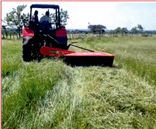
FIGURA 1. Segadora rotativa acoplada al tractor.
