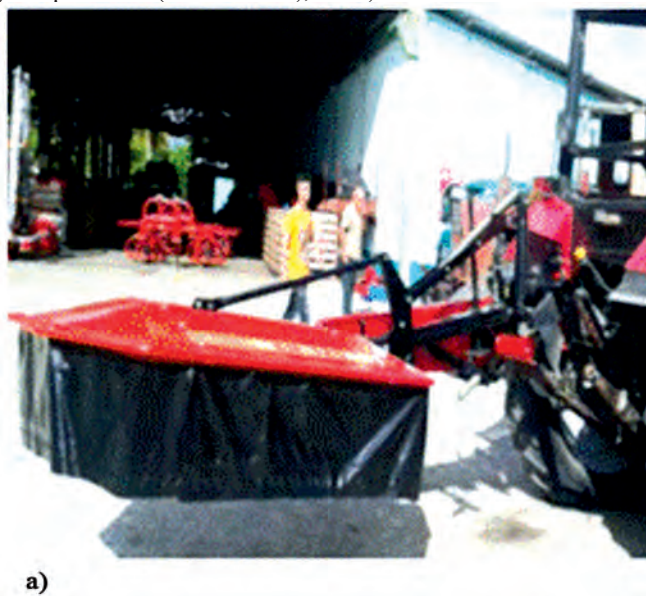
FIGURA 1. Segadora rotativa acoplada al tractor.
