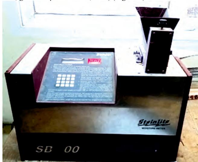
FIGURA 2. Medidor de humedad de granos Steinlite, modelo SB900.
