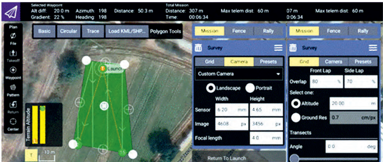
FIGURA 6. Ajuste de traslape y cámara en Qground Control.
