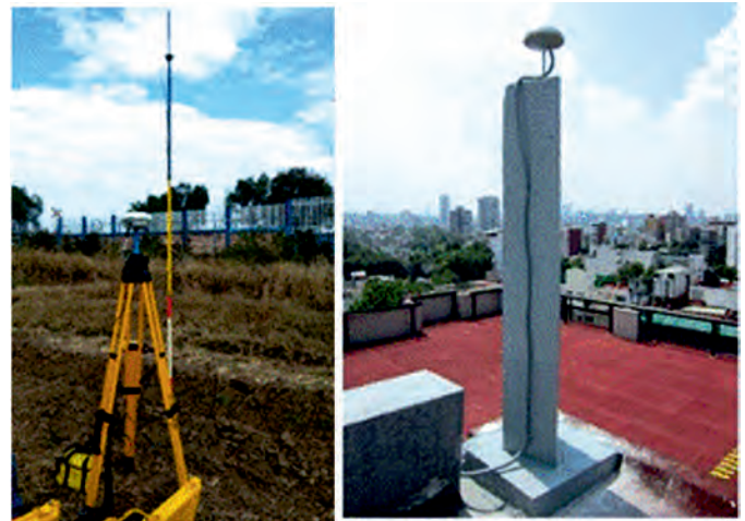
A) Sistema GNSS Trimble B) Receptor GPS de la RGNA
