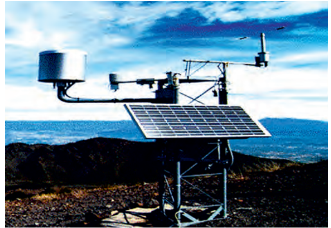
FIGURA 4. Estación meteorológica automatizada para el registro de variaciones atmosféricas de interés agrícola que interactúan con los cultivos.
