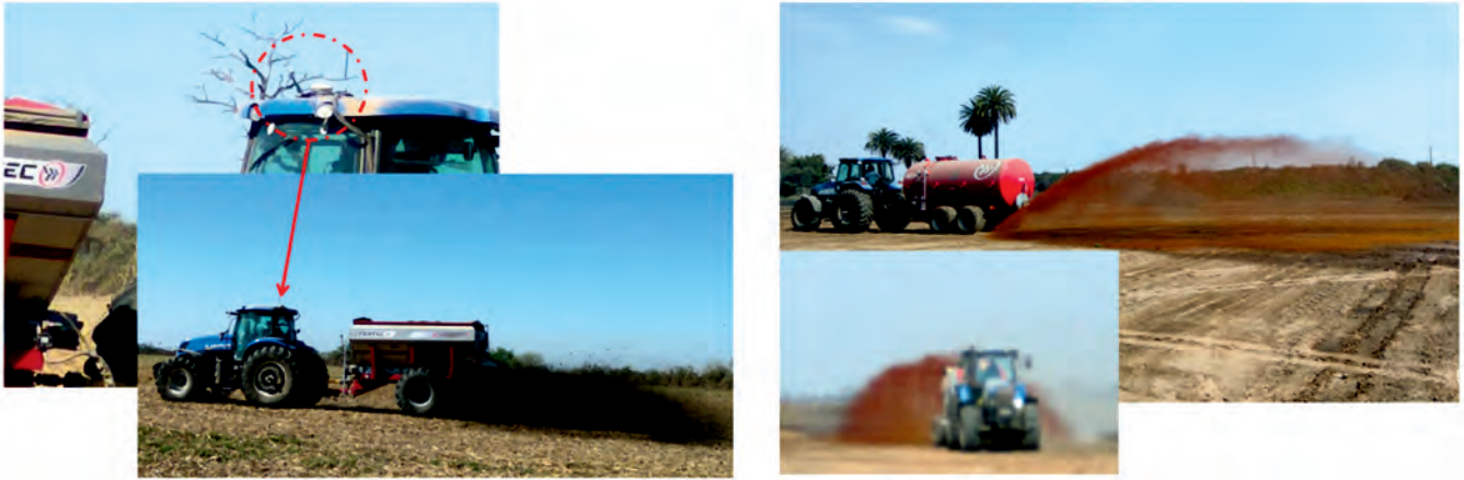
FIGURA 11. Máquinas de distribución de compost y vinaza. Obsérvese la antena que permite su distribución espacial. Esta facilidad (dentro del concepto de AP), permite mejor distribución y garantizar su distribución las 24 horas del día.
