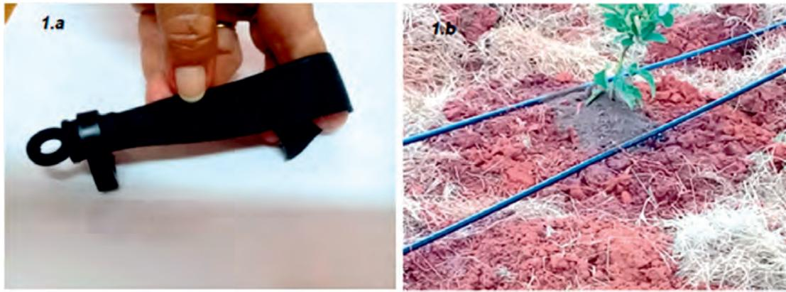
FIGURA 1. (a) Muestra de la cinta geotextil porosa y (b) funcionamiento de la cinta en el campo.
