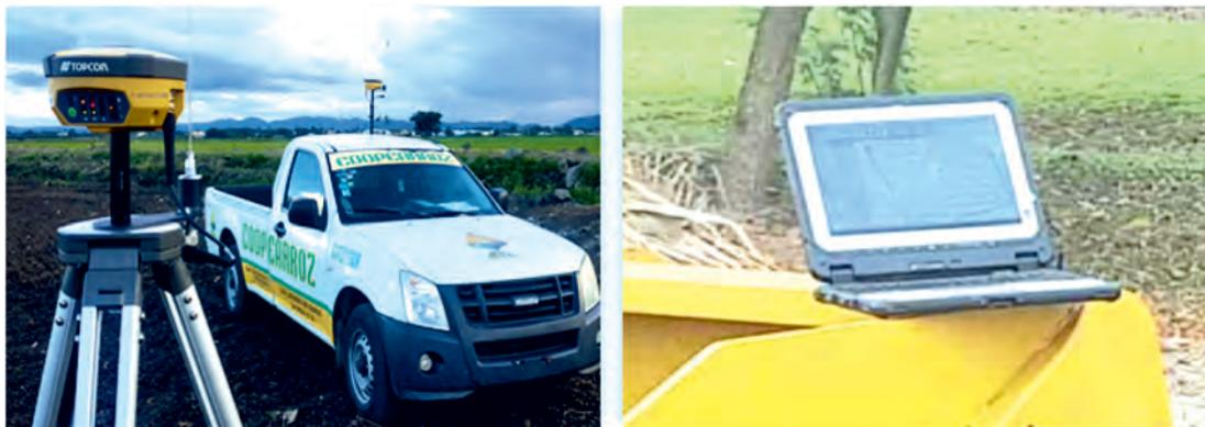
FIGURA 1. Estación Base, Estación Móvil y laptop corriendo software AGform-3D.
