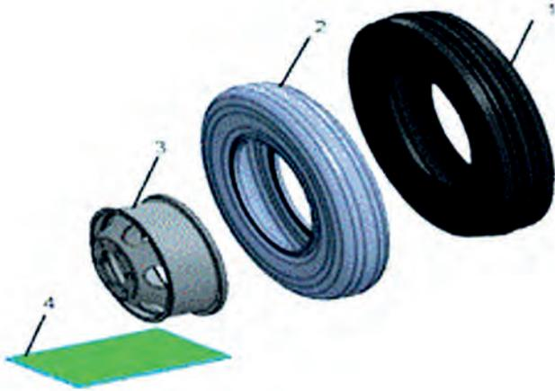
FIGURA 2. Elementos componentes del modelo uno para el neumático 7.50-20. 1. Capa exterior del neumático (Bandas laterales y de rodadura); 2. Capa interior del neumático compuesto por cuerdas y caucho; 3. Llanta metálica y 4. Superficie rígida de apoyo.
