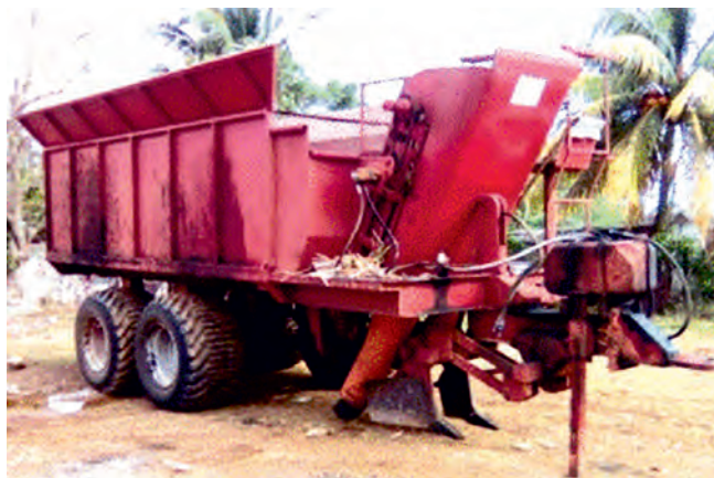
FIGURA 1. Plantadora AZT 6000 fabricada en la División de Talleres “Enrique Villegas” de Villa Clara.
