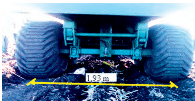
FIGURA 4. Ubicación de la plantadora en la zona de tráfico.
