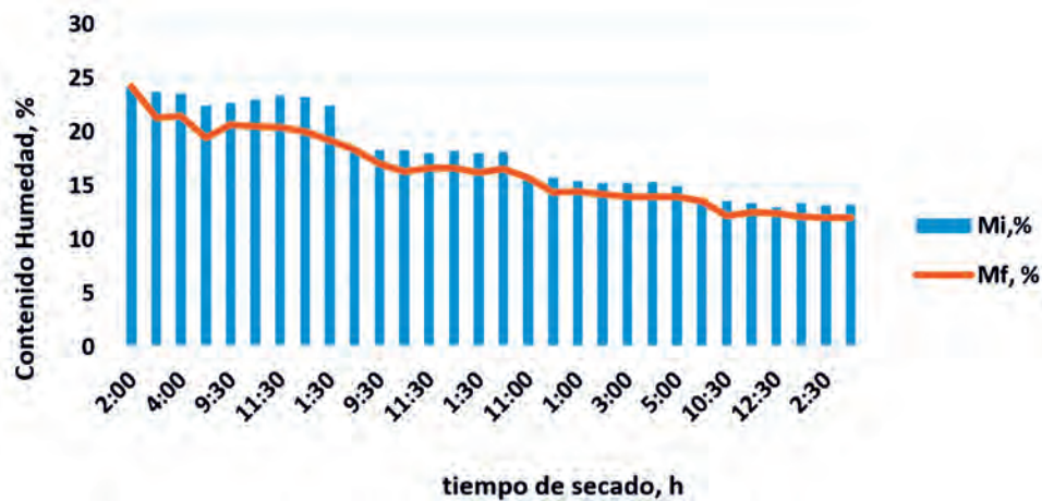
FIGURA 1. Comportamiento del descenso del contenido de humedad en función del tiempo de secado en el Lote I.
