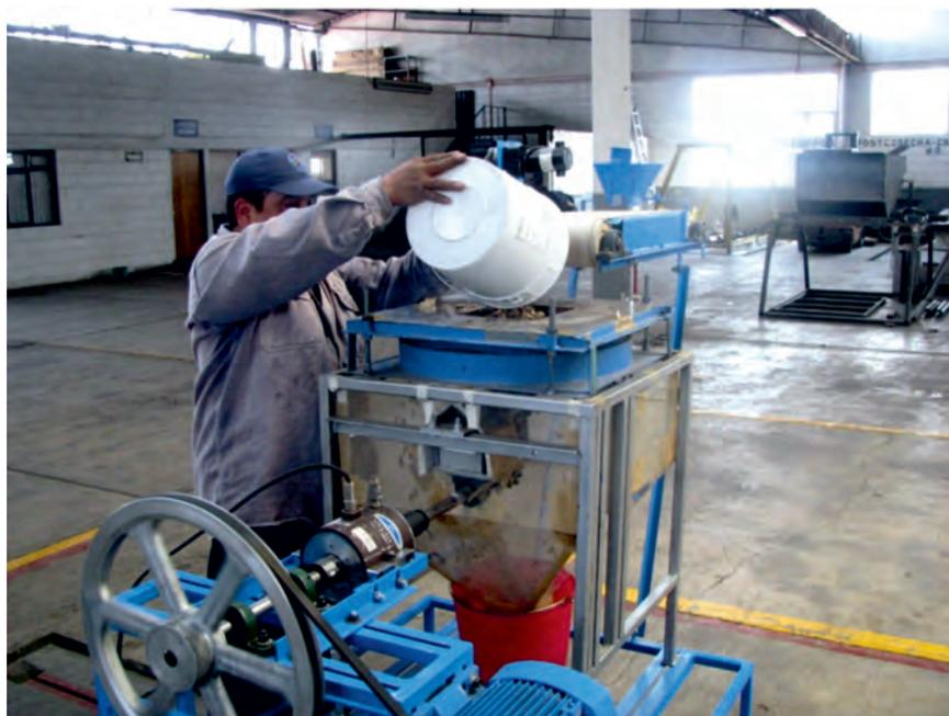
FIGURA 2. Maqueta experimental de descascarado.
