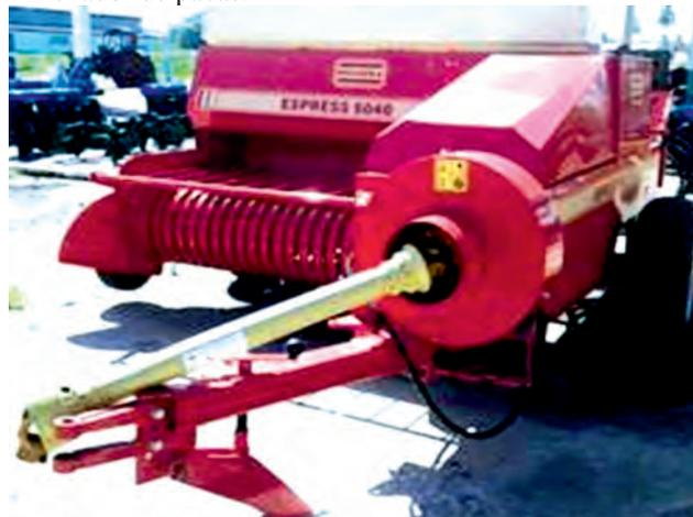
FIGURA 2. Máquina empacadora
