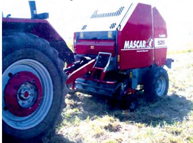
FIGURA 1. Máquina rotoempacadora.
