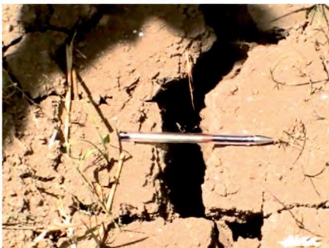
FIGURA 2. Grietas de hasta 8 pulgadas de profundidad.
